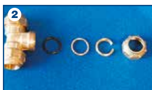
2 Terminale di giunzione: componenti
