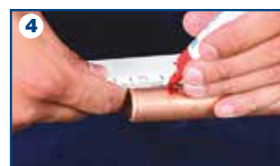
4 Marcatura profondità di giunzione
