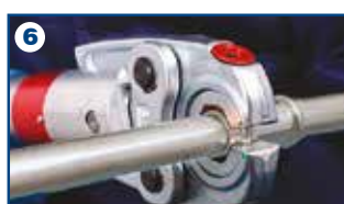
Allineamento delle ganasce al raccordo
