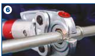
6 Allineamento delle ganasce al raccordo
