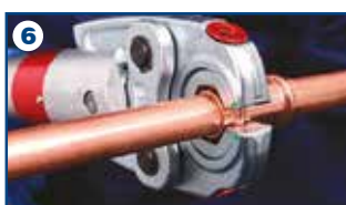
Allineamento delle ganasce al raccordo
