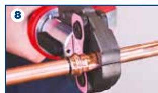
8 Completare il ciclo di pressatura. Pressare una sola volta
