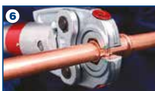
Allineamento delle ganasce al raccordo
